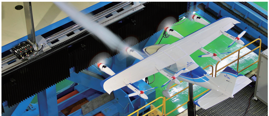
OPPAV: 풍동시험 중인 미래형 개인비행기 (항공우주연구원)
